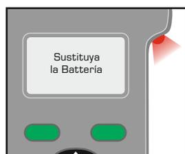
Si parpadea el indicador de estado, deberá recargar o sustituir la Battery Baton pronto.
